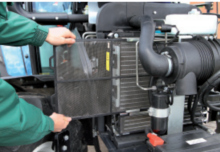
Schmutzsieb und Kühler lassen sich für Reinigungsarbeiten seitlich ausziehen.
