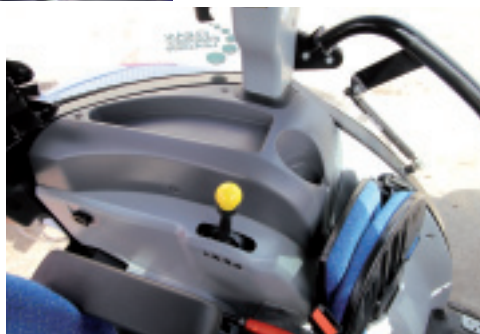
Links vom Fahrersitz: Ablageflächen, Vorwahlhebel für Zapfwelldrehzahl und ein klappbarer Beifahrersitz.
