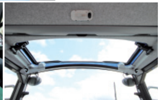
Ein großes Ausstelldach aus Glas bietet gute Sicht bei Frontladerarbeiten.
