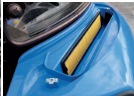
Die Kabinenluftfilter sind in den Kotflügeln integriert.
