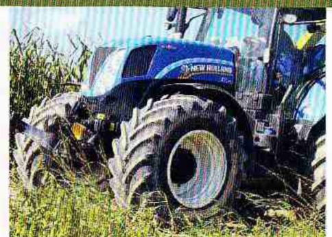
T7-Traktoren fahren mit ABS. Die ABS-SuperSteer-Technik bremst das kurveninnere Rad ab: schneller um die Kurve mit weniger Narbenschäden.
