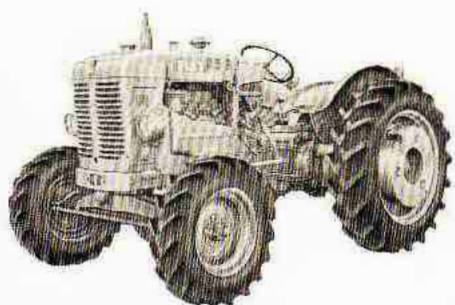
Fiat stellt den ersten Traktor mit Vierradantrieb vor, den 25 R-DT. In den folgenden Jahren wird Fiat Weltmarktführer von Allradtraktoren.
