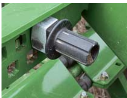
Mit dem Exzenterbolzen im Lochraster kann der Versatz der Scheiben zueinander einfach verstellt werden.
