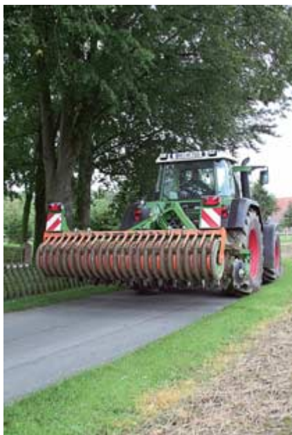
Zur Straßenfahrt kann ohne abzu- steigen umgebaut werden.
