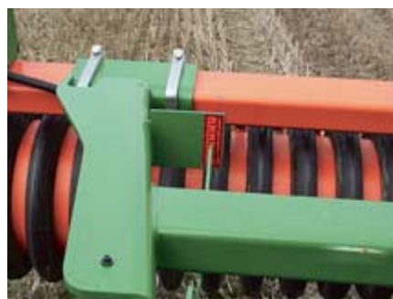
Eine gut sichtbare Skala informiert den Fahrer über die Arbeitstiefe. Die Ziffern entsprechen dabei recht genau der tatsächlichen Tiefe.
