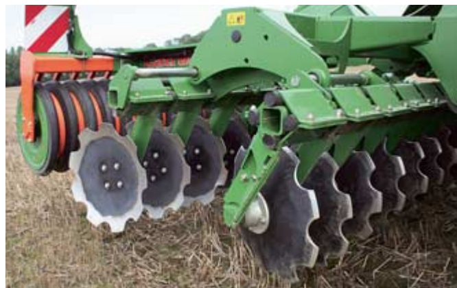
Die gezackten Scheiben haben einen Durchmesser von 51 cm. Aufhängung, Lager etc. bleiben aber gleich. Zukünftig gibt es neben der Keilringwalze fünf weitere Nachlaufwalzen im Programm.
