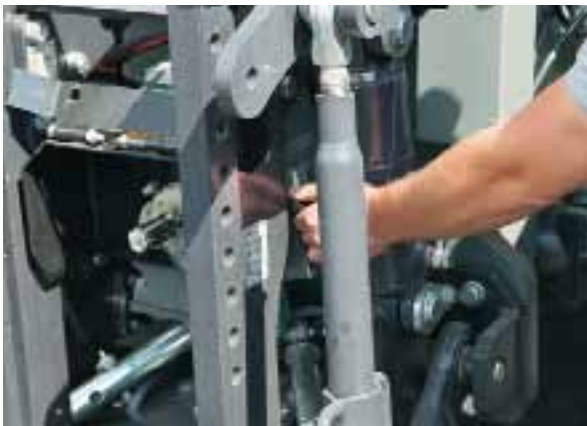
Zwischen 540er und 1 000er Zapfwelle wird hinten an der Maschine per Hebel umgeschaltet (Bild links). Bei Hubwerkbetrieb wird der Pendelweg der Hinterachse hydraulisch gesperrt.
