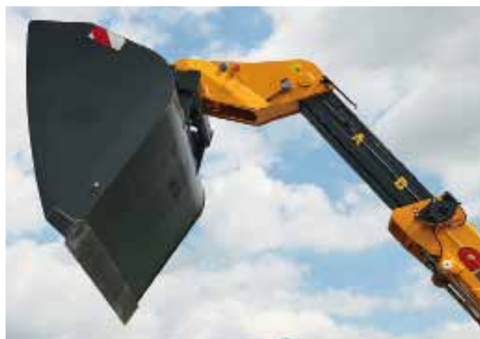
Der Kippbereich wurde durch ein Zwischengelenk vergrößert. An dem Auskippwinkel der angebauten Schaufel hatten wir bei unserem Einsatz nichts auszusetzen.
