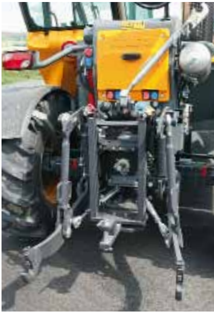
Das 4-t-Hubwerk und die mechanische Zapfwelle gehören zur Serienausstattung beim Dieci Agri Tech 35.7 VS.
