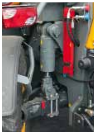
Zwischen 540er und 1 000er Zapfwelle wird hinten an der Maschine per Hebel umgeschaltet (Bild links). Bei Hubwerkbetrieb wird der Pendelweg der Hinterachse hydraulisch gesperrt.
