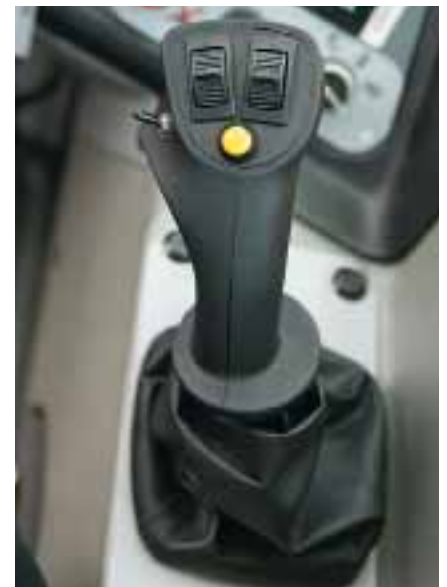
Joystick mit kleinem Schalter für die Fahrtrichtungsumkehr von Dieci Deutschland.
