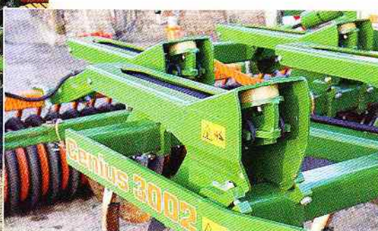
Die stark gebogenen 3D-Zinken samt Überlastsicherung mit zwei wartungsfreien Spiralfedern stammen vom Centaur. Das Auslösemoment beträgt etwa 390 daN und könnte etwas höher sein.
