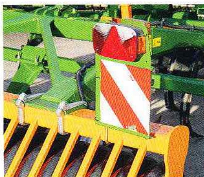
Die Beleuchtung ist sehr gut, die 58-cm-Keilringwalze ist zwar schwer und nicht gerade billig, aber sie ist auch sehr einsetzsicher.
