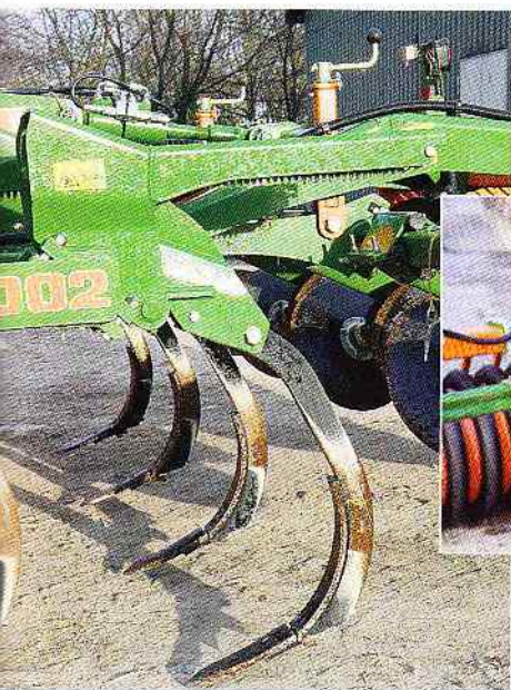
Die stark gebogenen 3D-Zinken samt Überlastsicherung mit zwei wartungsfreien Spiralfedern stammen vom Centaur. Das Auslösemoment beträgt etwa 390 daN und könnte etwas höher sein.
