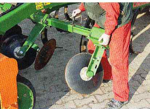
Die einebnenden Hohl-scheiben machen eine super Arbeit. Die Randscheiben lassen sich sehr gut ein- und ausschieben und verfügen über ordentliche Justierungsmöglichkeiten in den Langlöchern.
