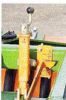
Die zentrale hydraulische Tiefenverstellung haben wir gern genutzt. Neben der Verstellspindel für die Hohlscheiben gibt es eine gute Skala, die über die Arbeitstiefe informiert.
